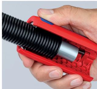
Auch für Schutzrohre von Aluverbundrohren im Sanitärbereich bis Ø 32 mm
