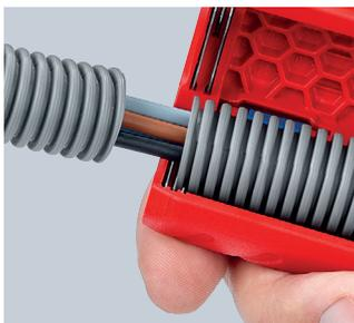
Saubere Schnittkante und keine Beschädigung der innen liegenden Kabel, da der Schnitt immer oben auf der Welle erfolgt
