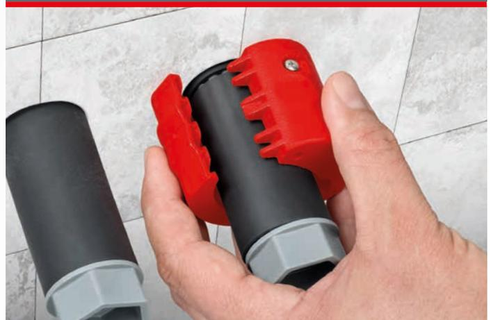
Durch die einzigartige Konstruktion des drehbaren Messerblocks lassen sich Tropf- und Dichthülsen zuverlässig 2 bis 3 mm vor der Wand einkürzen, um Feuchtigkeit sicher abzuleiten.
