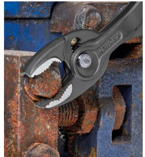
Das durchgesteckte Zangengelenk ist robust und flexibel: Werkstücke zwischen 4 und 22 mm hält die Zange sicher fest.
