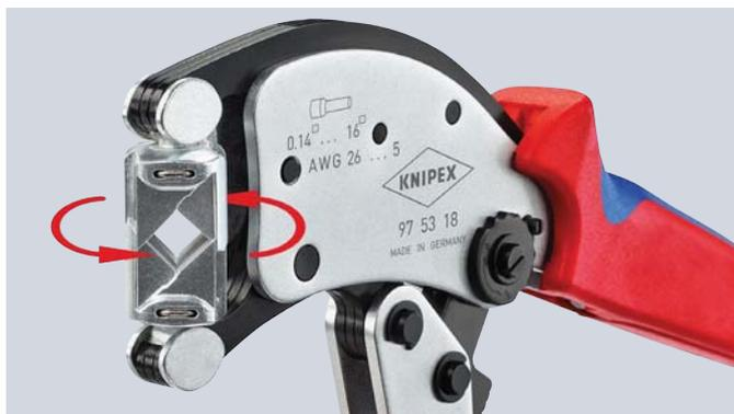
360° drehbarer Crimpkopf für beste Zugänglichkeit auch unter beengten Verhältnissen
