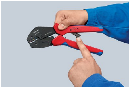
Servicehebel einklappen und Zange durchdrücken – bereit für den nächsten Einsatz
