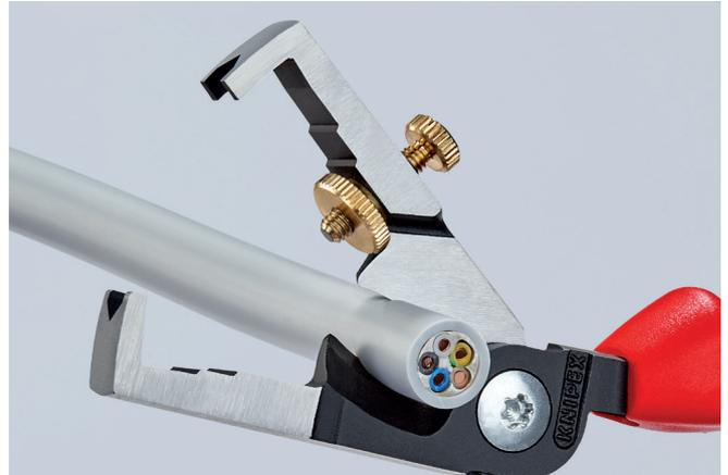
Induktiv gehärtete Scherschneide mit Präzisionsschliff zum quetschfreien Schneiden von Kupferkabeln bis Ø 15 mm (5 x 2,5 mm<sup>2</sup>)
